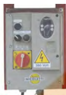
VEL-VAR. Velocidad variable 0-75 rpm Gestión mediante convertidor con manipulador.
