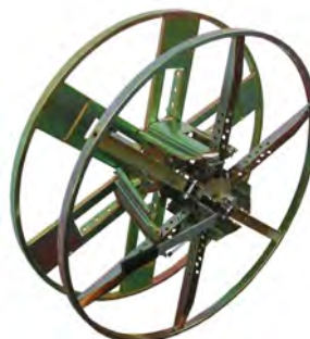
OE-S. Carrete metálico para realizar rollos de cables. Núcleo de bobinado cilíndrico que se expande para facilitar la extracción del rollo. Posibilidad de variar el núcleo de 320 a 620 mm Ø. paso de 50 mm. Dimensiones totales: ancho de 800 mm 500mm Peso: 40 kg Rollos de 750mm Ø máximo. fijo mínimo 115mm Ø, máximo 220mm Ø. Peso 250 kgs
