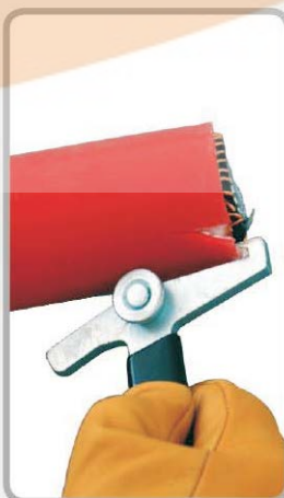
Retirar la funda con el separador
