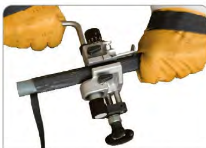
Cortar y retirar la funda de semiconductores pelables
