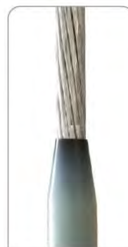
Rebajar el extremo de un aislante en forma de cono
