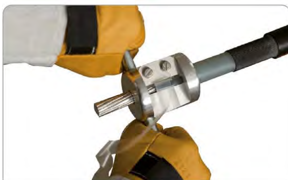
Rebajar el extremo de un aislante en forma de cono
