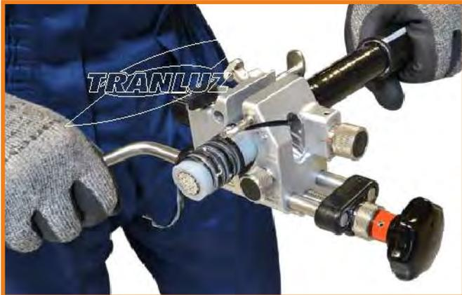
13) La cinta se enrolla automáticamente sobre el aislante. Seguir mecanizando el semiconductor hasta la longitud de pelado deseada manipulando a velocidad constante y regular.
