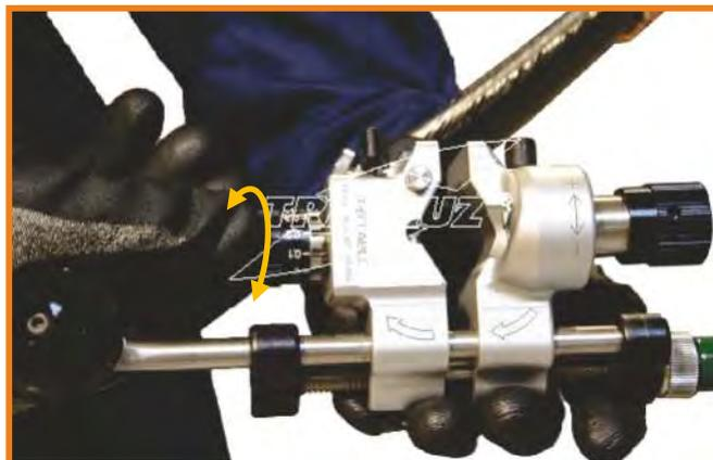
2) Ajustar la profundidad de la cuchilla con el botón graduado (tirar - ajustar - empujar) de un 0,1mm inferior al espesor del semiconductor. Ejemplo: para un semiconductor de 0,7mm, ajustar la cuchilla en 0,6mm.
