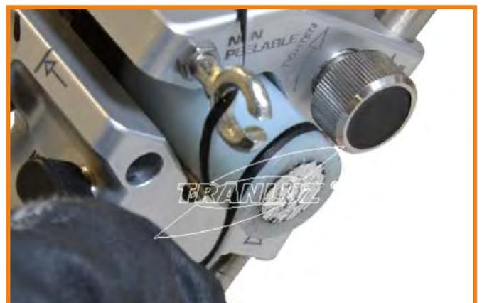
12) Lo antes posible, pasar la cinta semiconductor dentro de la guía de extracción y enrollarla sobre la extremidad del aislante en el sentido anti-horario (se puede hacer un nudo).
