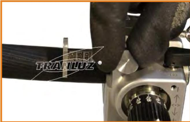
7) Bloquear el ajuste del tope con el tornillo de bloqueo.
