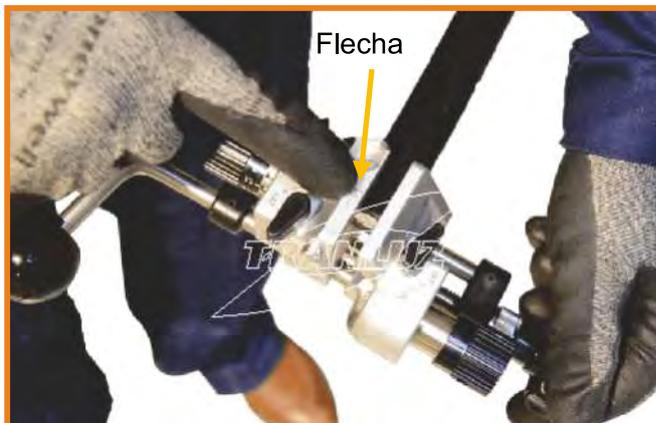
4) Hacer coincidir la extremidad del cable con la flecha indicada en la herramienta.
