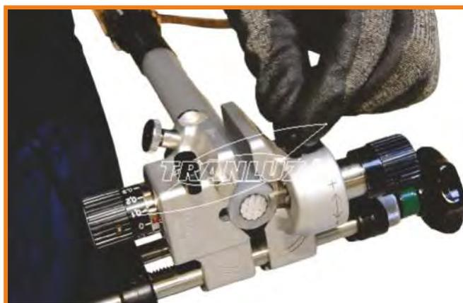
4) Poner la palanca en posición "ON" (I): corte helicoidal
