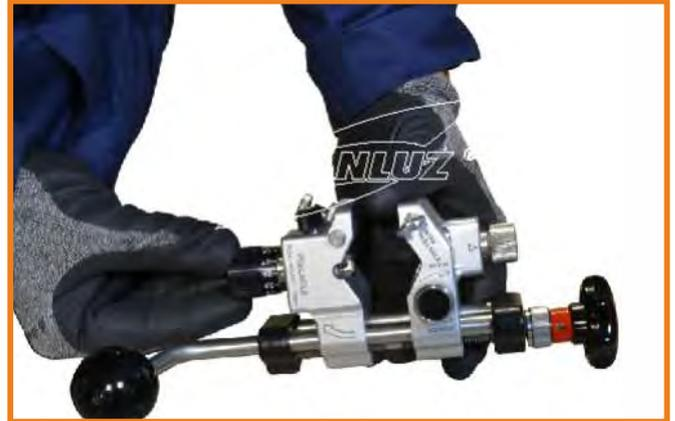
2) Ajustar la profundidad de la cuchilla con el botón graduado de un 0,1mm inferior al espesor del semiconductor (tirar-ajustar-empujar). Ejemplo: para un semiconductor de 0,8mm, ajustar la cuchilla en 0,7mm.
