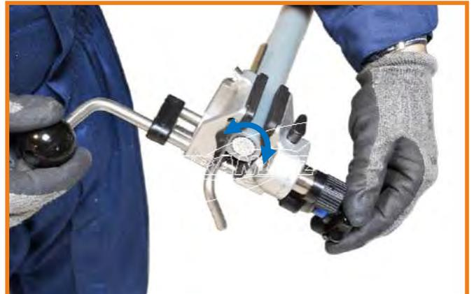
3) Colocar la herramienta sobre la extremidad del cable para permitir el ajuste de la cuchilla y para girar libremente sin dejar juego.
