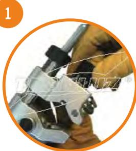
1. Ajustar la profundidad de corte con el botón graduado (de 0.1mm a 1.2mm) Tirar del botón, ajustar la profundidad deseada. Consejo de aplicación: ajustar 0,1 mm menos del grosor de la semiconductora.
