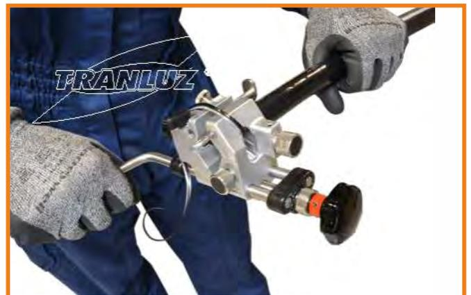
10) Empezar a mecanizar el semiconductor girando la herramienta en el sentido horario.
