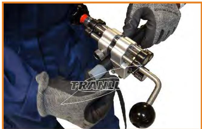
10) Al inicio, asegurarse de que la cuchilla no deje ninguna marca en el aislante. Ajustar la profundidad de corte si es necesario.
