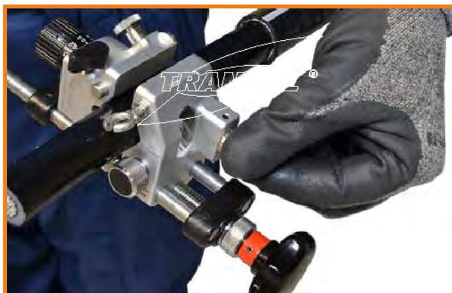
4) Girar la rueda de ajuste para poner la cuchilla en contacto con el semiconductor. Sentido (+): Corte más profundo. Sentido (-): Corte menos profundo
