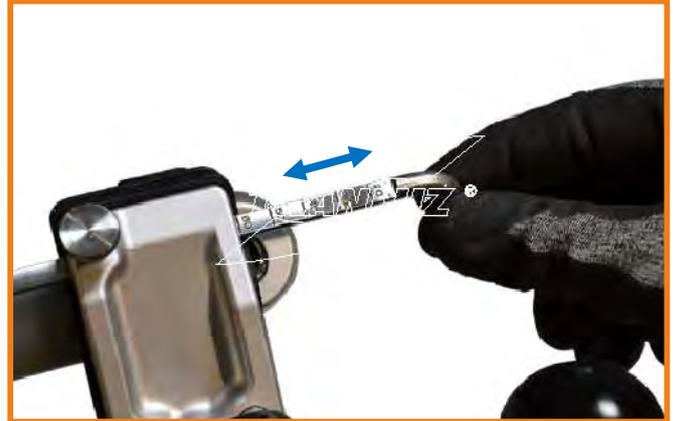
1) Ajustar el tope según la longitud de pelado deseada (desde 20 mm hasta 10 mm)
