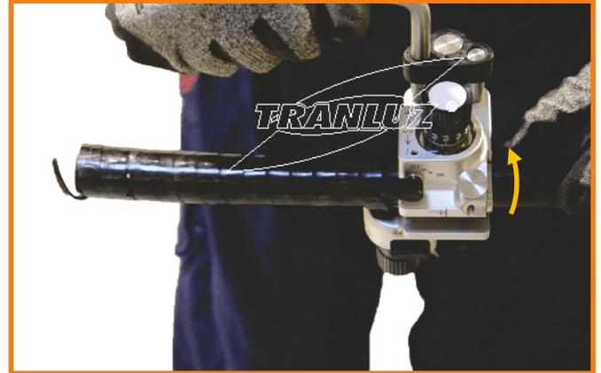
8) Cortar la cubierta externa hasta la longitud deseada. Parar la herramienta y dar 1/2 giro atrás para liberar la cuchilla. **(NOTA: la medida entre la cuchilla y la extremidad de la herramienta es de 50 mm).**
