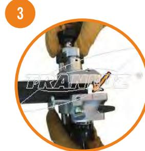
3. Colocar la herramienta sobre el cable. Apretar la herramienta lo suficientemente fuerte para que pueda girar pero que no se mueva. Cuidado: la otra cuchilla (lado opuesto) debe estar recogida. (POLY SCP, OUT SCP NP)
