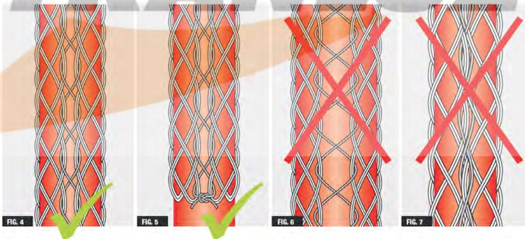
FIG. 4 Al final del procedimiento la costura deberá ser regular y por consiguiente el cierre de la malla y una correcta disposición en el cable.
